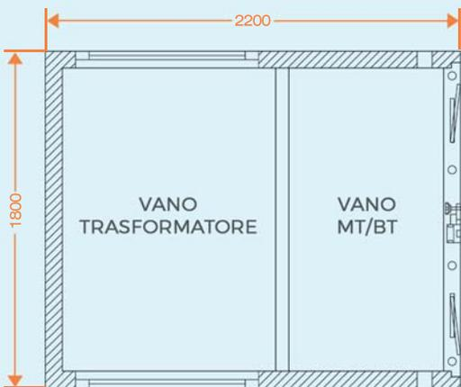
Delta Technology implementa la propria gamma di prodotti inserendo la nuova Cabina Elettrica Omologata ENEL tipo MICROBOX PLUS "DG 10200". Il Box, realizzato come struttura monoblocco con copertura rimovibile e vano cavi solidale con le pareti, viene utilizzato come punto di trasformazione sezionabile collegato in antenna, in grado di ospitare un Trasformatore fino a 250kVA, Quadri MT/BT ed un concentratore omologati ENEL.
